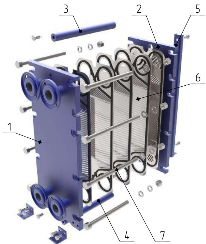
Пластины с прокладками подвешиваются и выравниваются с помощью верхней (3) и нижней (4) направляющих и при помощи стяжных болтов (7) равномерно сжаты в пакет (длина стяжки зависит от количества пластин).
